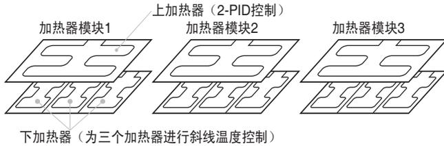
对于组设定，加热器首先被分为几组，并决定每个组使用倾斜温度控制还是 2-PID 控制。本例中，有三个组为三个通道进行倾斜温度控制，另有一个组为三个通道进行 2-PID 控制。组的分割如下所示。
