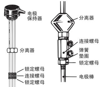
注：使用分离器时，请注意安装方向，不要让连接螺母的螺钉碰到其它电极棒连接螺母的螺钉。
