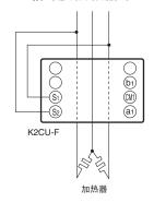
注: K2CU-F的本体部虚线表示电线贯通。
