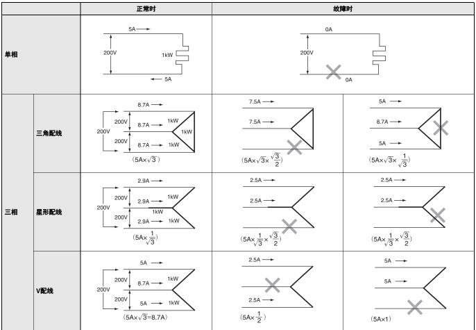
注: 将200V、 1kW的加热器用于单相或三相时的电流值。
