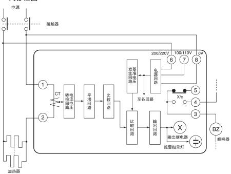
※需要同时接通加热器和K2CU的控制电源⑥⑧或⑦⑧。
