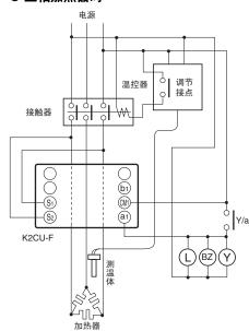
**注1.** K2CU-F的本体部虚线表示电线贯通。
