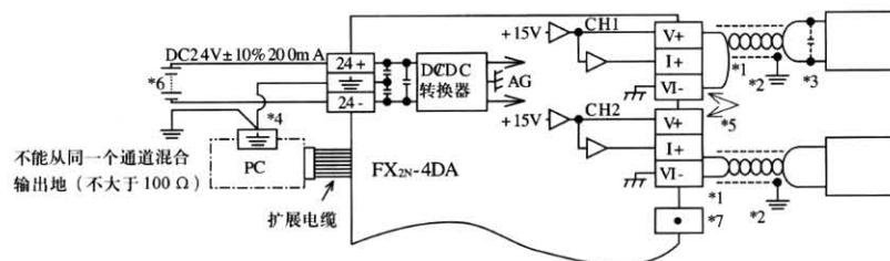
\*1 对于模拟输出使用双绞屏蔽电缆。电缆应远离电源线或其它可能产生电气干扰的电线。
