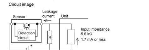
$R(k\Omega) < 1.7(mA) / Leakage\ current(mA) - 1.7(mA) \times 5.6(k\Omega)$
