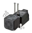
3. 将检测面旋转到必要的方向后,嵌入本体外壳。(可旋转角度为 0°、90°、180°、270°。 不要随意旋转。)
